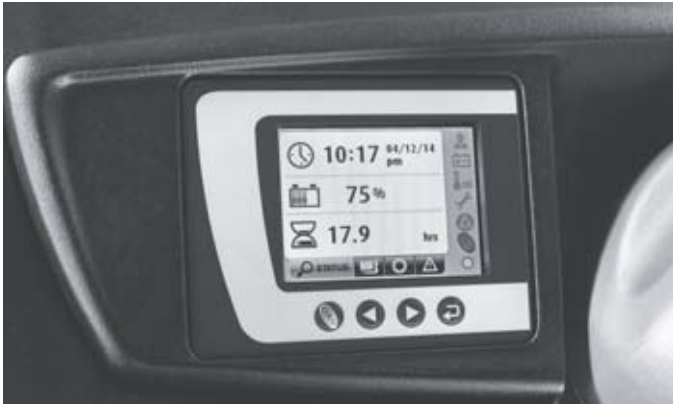
Een kleurendisplay met taalonafhankelijke symbolen waarop alle belangrijke functies in één oogopslag te zien zijn
