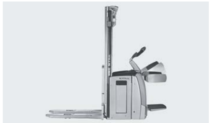
Veilig staan te allen tijde: zijwaarts verstelbare beschermende armen zorgen dat rijden altijd veilig is
