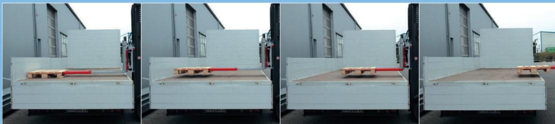
Durwen Teleskopgabelzinken sind ideal um LKW einseitig zu Be- und Entladen. Durch das einseitige Be- und Entladen spart man bis zu 30% Zeit gegenüber dem beidseitigen Be- und Entladen ein.
