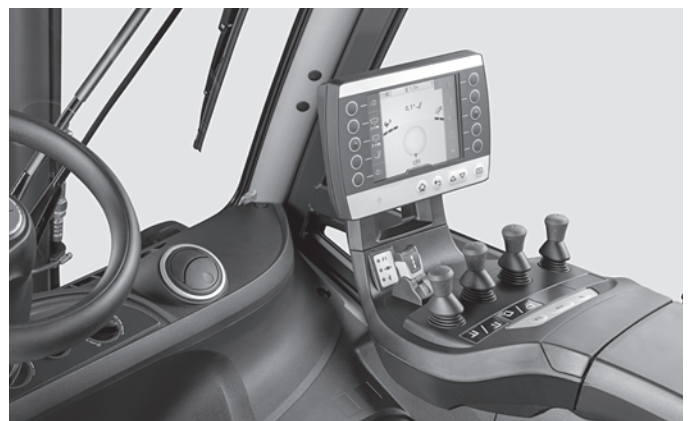
Veilige en intuïtieve bediening met de STILL Easy Control display en bediening
