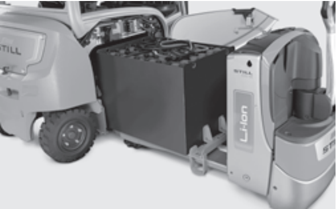
Batterij verwisselen met elektrische pallettruck
