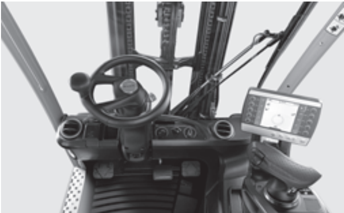
Werkruimte met display en Joystick 4Plus bediening en verwarming
