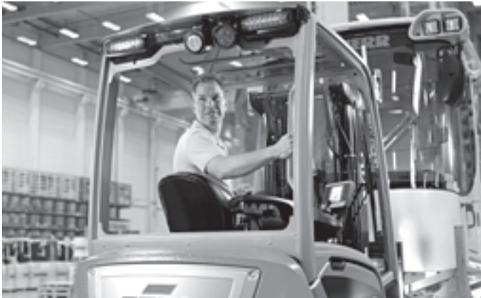
Draaibare stoelbeugel met optionele claxonbediening voor ergonomisch achteruitrijden
