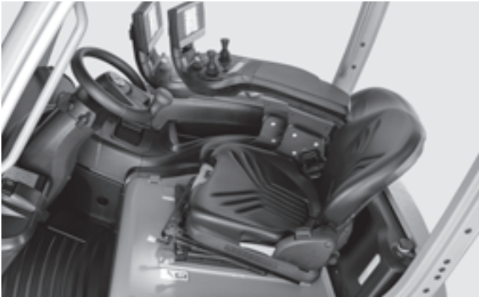
Draaistoel voor comfortabel achteruit rijden
