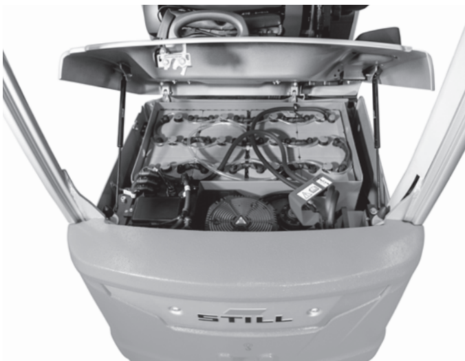
Zowel batterij als aandrijving zijn makkelijk toegankelijk – voor maximale beschikbaarheid en eenvoudig onderhoud
