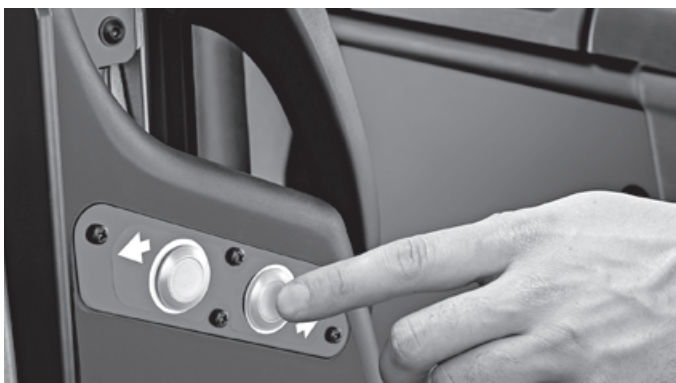
Dubbelzijdige meerrijbediening voor verhoogde omslagcapaciteit bij hoge orderpick-dichtheid
