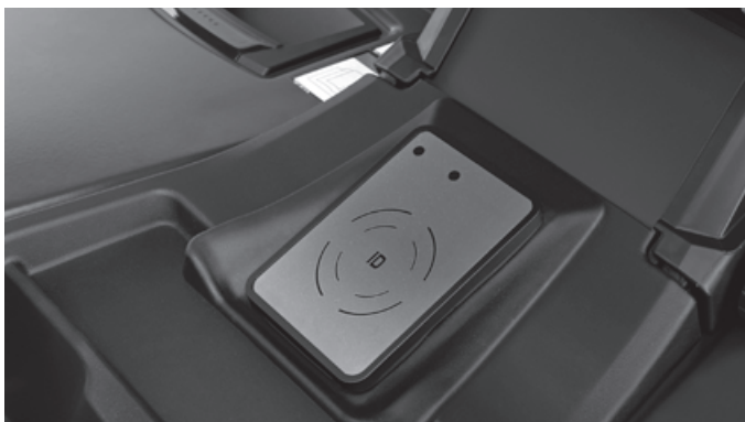
Meerdere toegangscontrolemogelijkheden: optionele toegang via FleetManager of pincode, evenals standaard toegang via sleutelschakelaar
