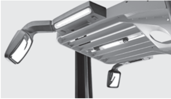
Individueel instelbare achteruitkijkspiegel voor het eenvoudig inrijden in smalle gangen
