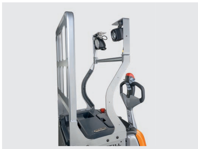
Maximale veiligheid bij het laden en lossen van vrachtwagens dankzij STILL Safety Light en werkclampen
