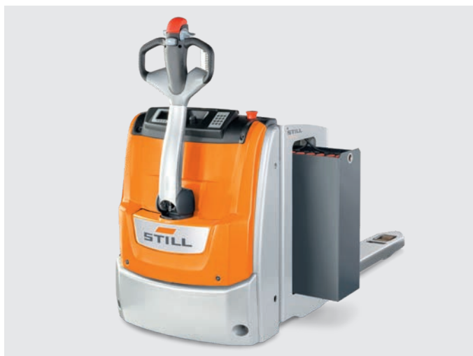
Altijd beschikbaar met Li-Ion technologie en batterijcapaciteiten tot 500 Ah
