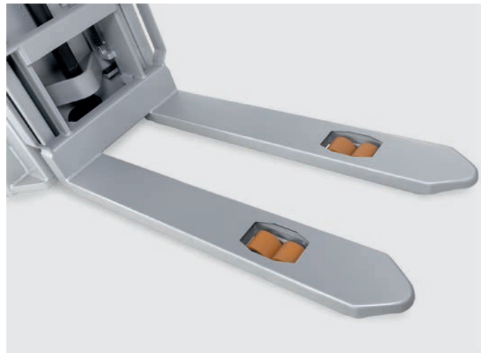
Afgeronde vorkuiteinden om pallets sneller en nauwkeuriger op te pakken
