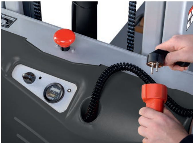
De ingebouwde oplader zorgt voor maximale inzetbaarheid en maakt decentraal opladen mogelijk
