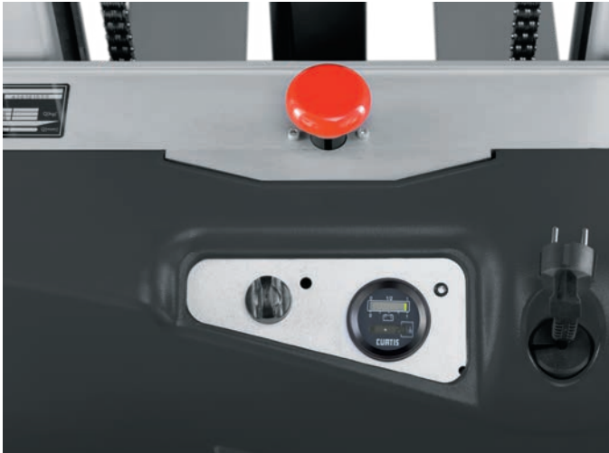
LED-display met accumeter en bedrijfsurenteller voor direct inzicht in alle belangrijke parameters
