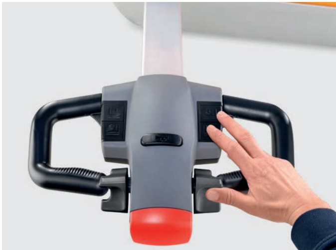
Moeiteloos werken dankzij de geoptimaliseerde dissel voor links- en rechtshandigen
