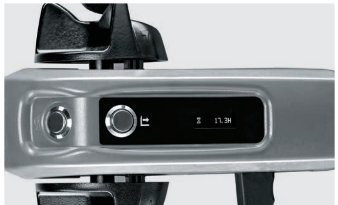
Alles goed in het zicht: het multifunctionele display geeft informatie over de bedrijfsuren, batterijstatus en onderhoudsinformatie
