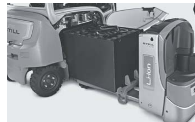
Batterij verwisselen met elektrische pallettruck
