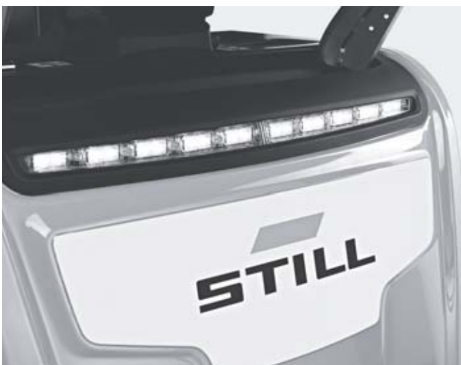
Intelligente LED-dagrijverlichting verhoogt de zichtbaarheid van het voertuig en geeft een lage accustatus aan
