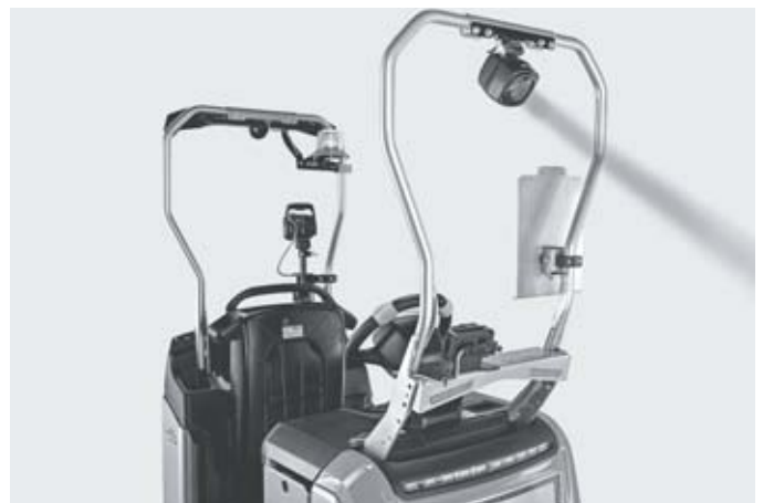
Beste zichtbaarheid van het voertuig dankzij het optionele Safety Light en Safety Light 4Plus voor de hoogste veiligheid van de bediener
