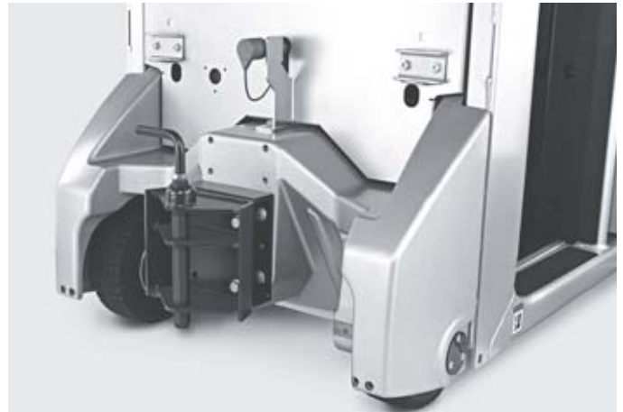
Flexibele toepassingsgebieden dankzij verschillende aansluitmogelijkheden voor sleepelementen en aanhangers
