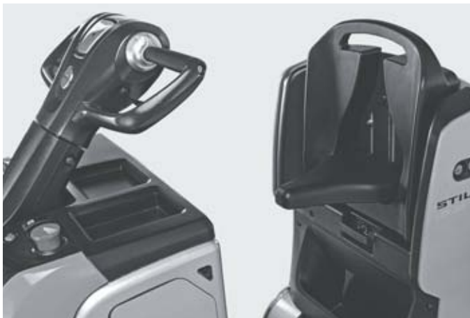
Opklapbare stoel vergemakkelijkt lange afstanden
