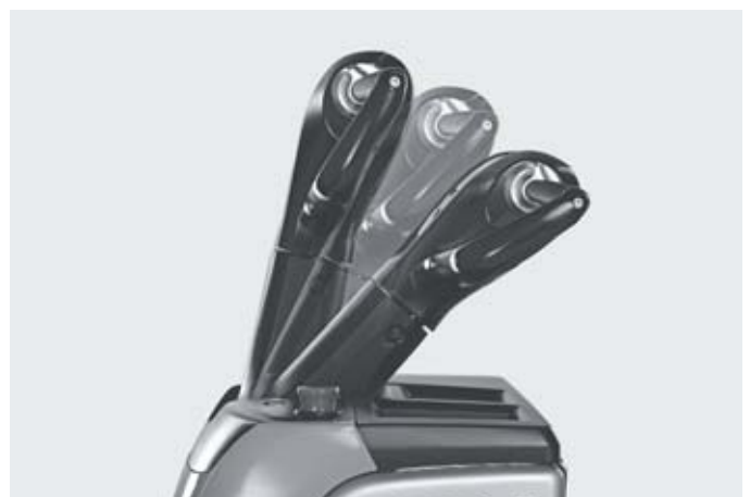
In hoogte verstelbare stuurvoorziening voor bestuurders van verschillend postuur
